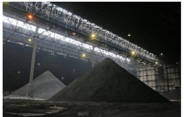
う石炭の量は約1万トン。ちょうどその山1つくらいである。現在は25種類の石炭を使っていて、3～5種類の石炭を混ぜている。価格を下げるため、中国、内モンゴルの石炭とカナダに近いアメリカ北部の石炭を混炭して使っている。これまでに99種類使っているので、あと1種類で100種類になる。その100種類目は、どこの石炭になるのだろうか？とても興味深い話だった。
